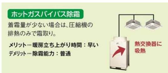
[図6 「ホットガスバイパス除霜」の特長]
