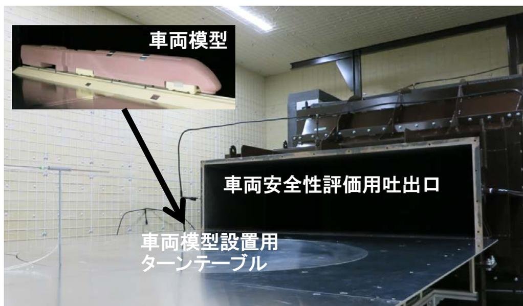
図2 車両安全性評価設備の概観
