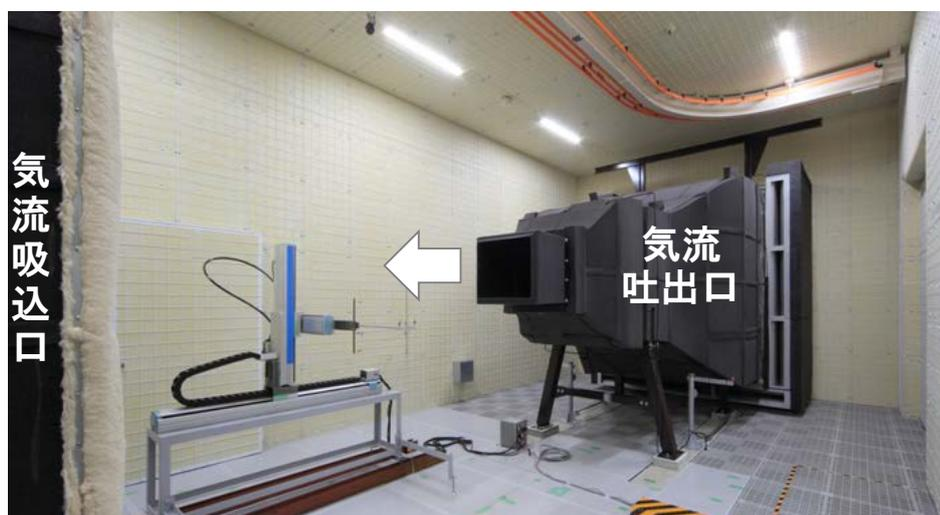
図1 開発した風洞設備の概観:測定室(無響室)内
