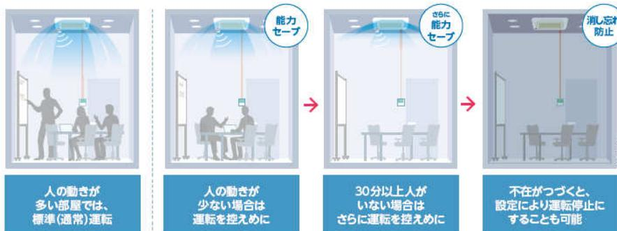
[図4 人感センサーによる能力セーブ<sup>(\*)4</sup>]
