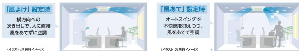
[図1 人感センサーによる「風よけ」「風あて」機能]
