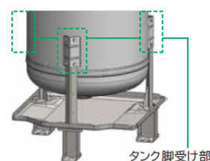
【図2 貯湯ユニット内タンクの構造イメージ図】
