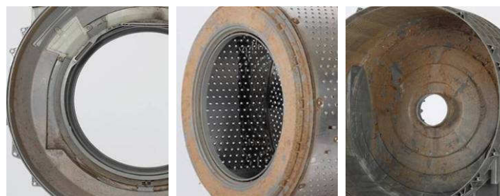
外槽前カバーの裏側の汚れ
