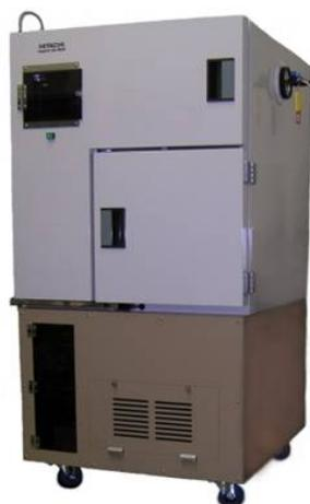
図1. 試作した完全閉鎖系の小型細胞自動培養装置
