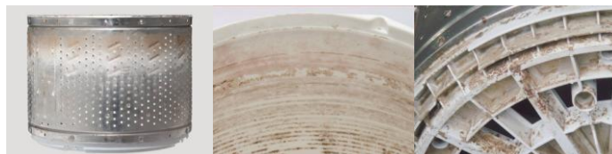
ステンレス槽外側の汚れ 外槽内側の汚れ ステンレス槽底面の汚れ
