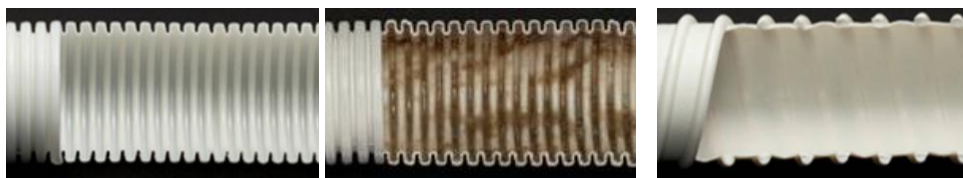
[図 3 従来排水ホース(左)と内部の汚れ(右)]
