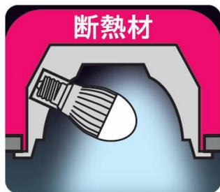
図 2. 断熱材施工器具装着イメージ図
