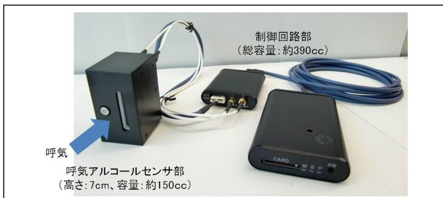
試作した呼気中アルコール検知システム
