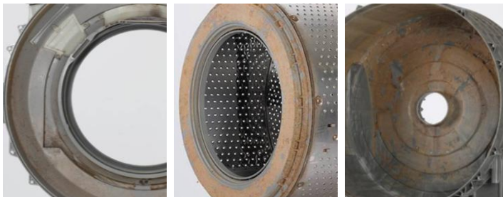
外槽前カバーの裏側の汚れ
