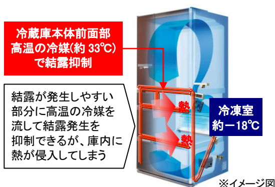
[図 5 結露抑制方法と庫内への熱侵入]
