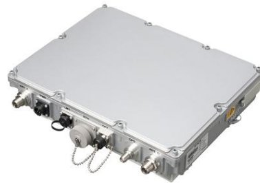
屋外超小型基地局「ER3000 Mobile WiMAX BS」
