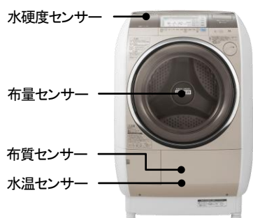
【図6 「[eco]水センサー」システム】
