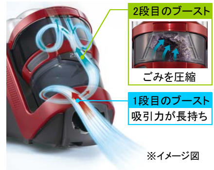
[図1 2 段ブーストサイクロンの構造]
