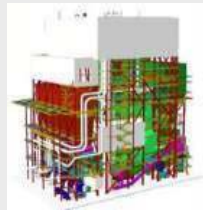
500MW級ボイラー概念設計
