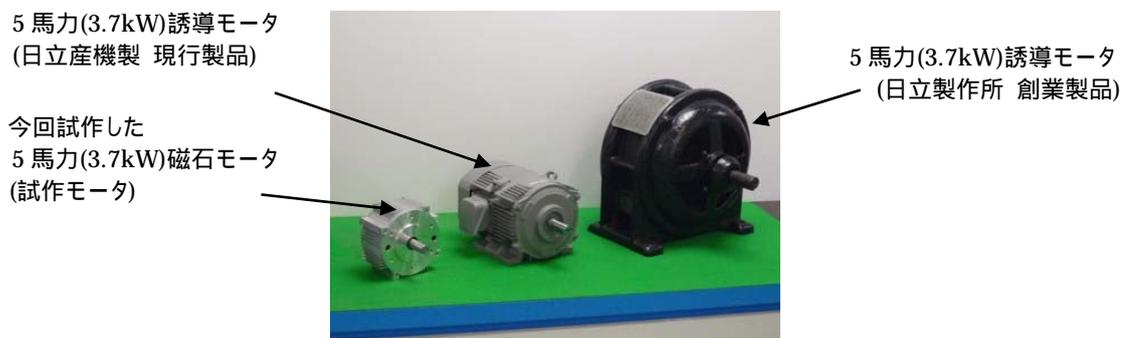
[写真] 試作モータ、現行モータと創業モータの外観比較
