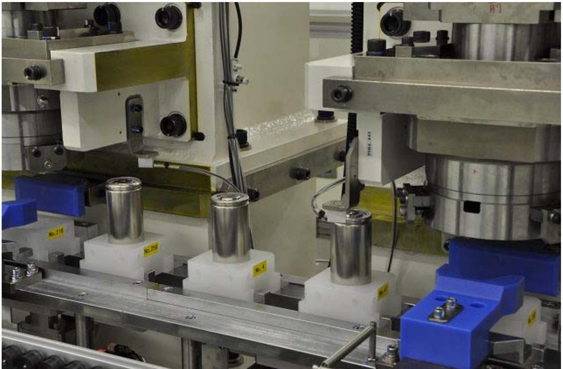
リチウムイオン電池組み立て工程
