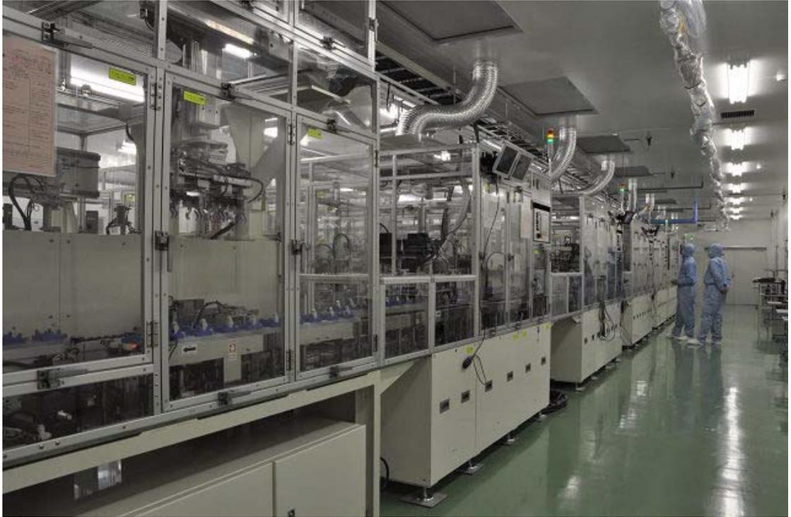
リチウムイオン電池セル組み立て工程
