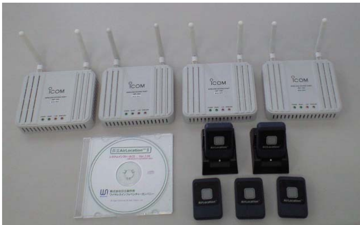
「日立 AirLocation AP-50W システム」の基本システム構成
