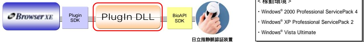
Biz/Browser と外部システムを連携させる「PluginSDK」と日立指静脈認証装置を制御する「BioAPI SDK」の提供により、日立指静脈認証装置と Biz/Browser を連携させるためのインタフェース「PlugIn DLL」の開発を可能とし、効率的な開発環境を実現します。
