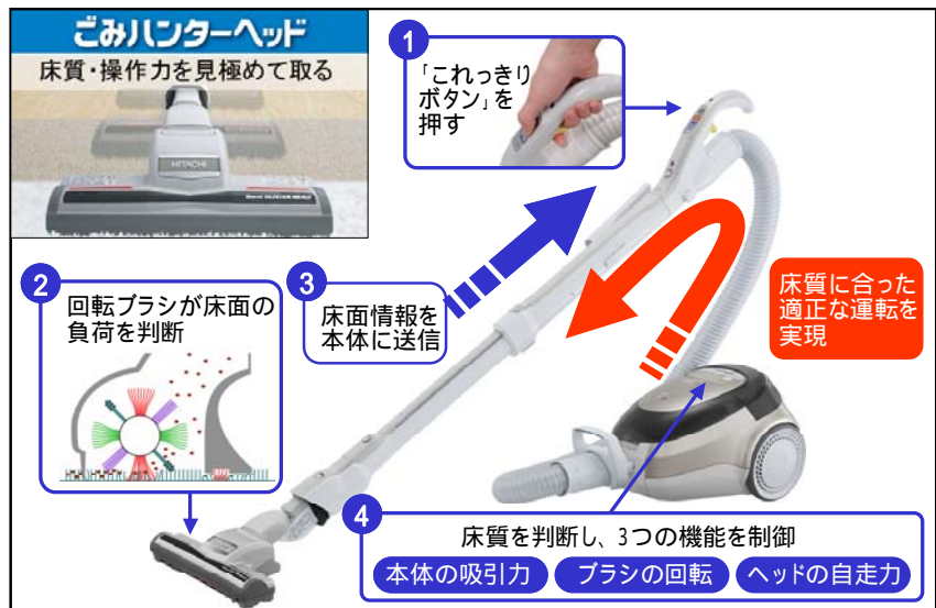
[図1 ごみハンターヘッドの制御のしくみ]
