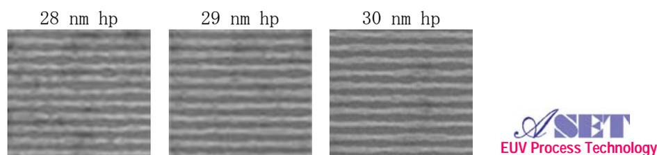
図 2. 新開発ネガ型フォトレジストのEUV露光によって得られたパターン(露光装置 ; HiNA)
