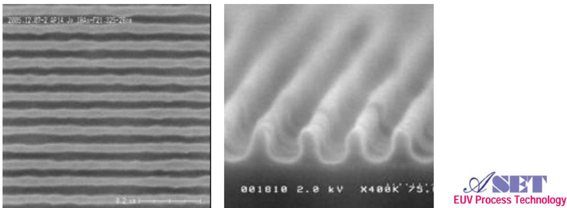
図1. 新開発ポジ型フォトレジストのEUV露光によって得られたhp 28 nmパターン(露光装置 ; HiNA)
