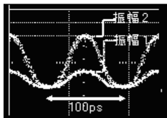
図2 8値光多値信号(10 ギガシンボル/秒、30 ギガビット/秒)の観測例
