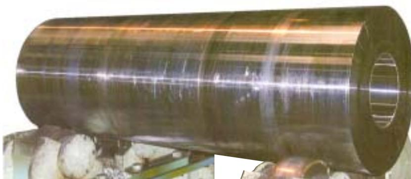
試作した極低温回転子軸(外径620mm)
