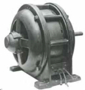
1910年 創業期の製品である5馬力電動機（モーター）
