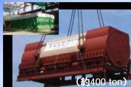
発電機ステータ
