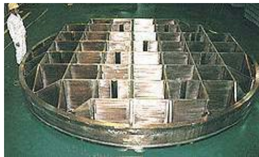
原子炉機器(上部格子板)
